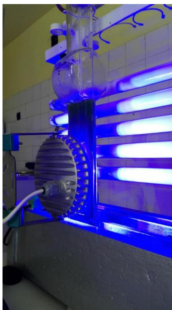
Фиг. 29. Установа за култивиране на Coelastrella sp. BGV при синьо LED осветяване
