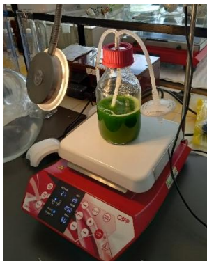
Фиг.2. Първи прототип на фотобиореактор - PPBR1, използван за размножаване на Chlorella vulgaris RJ1.
