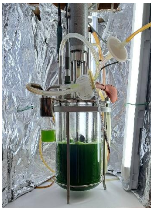
Фиг.9. Култивиране на Chlorella vulgaris RJ1 в биореактор Applikon – работен обем 2.5 l.
