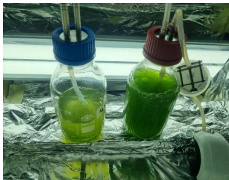
Фиг.7. Прототип на фотобиореактор - PPBR3, използван за размножаване на Chlorella vulgaris RJ1.
